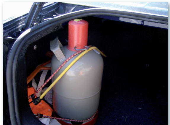
So ist es schon besser: wenn im Kofferraum transportiert werden muss, dann möglichst stehend und auf jeden Fall gesichert!
