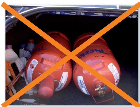
So keinesfalls: eine Kappe fehlt, Flaschen können wegrollen!
